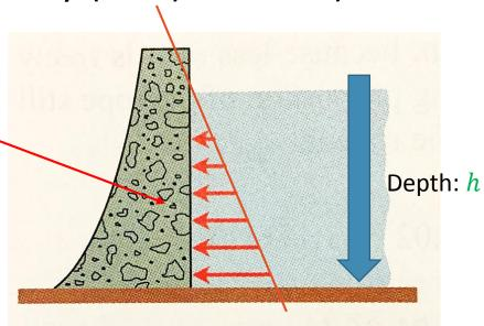
• Force exerted on a surface of area A by a constant pressure: 面積Aの外面に定圧によって加えられる力
