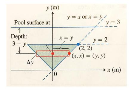
• A triangle vertical plate is underwater in a pool. Compute the force exerted by the water on the surface of the plate. (プールの水面下に垂直三角形の平板がある。 平板の一面に流体によって加えられる力の全体を計算せよ)。
